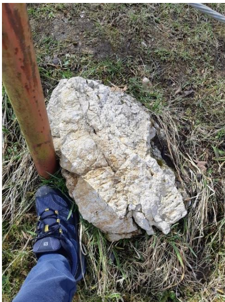
Slika 6 Skalni blok za objektom Partizanska pot 7. Dimenzije 0,6x0,35x0,25 m – 140 kg (številka 1)
